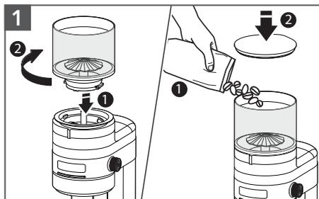
Coloque la tolva superior en la máquina con el icono de bloqueo hacia delante. Gire la tolva superior hasta que encaje en su sitio.
