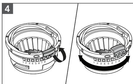
Levante el pestillo de microajuste del disco superior. A continuación, gire el disco superior hasta el ajuste deseado y vuelva a colocar el pestillo de ajuste en su sitio.
