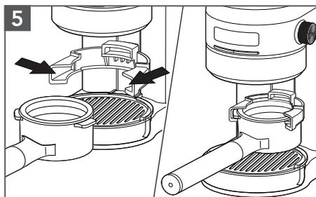
**Para moler en el portafiltros:** si utiliza un portafiltros comercial (58 mm), insértelo en las guías centrales del soporte del portafiltros.
