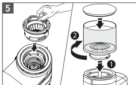
Vuelva a colocar el disco superior en su sitio y gírelo en el sentido de las agujas del reloj para fijarlo.
